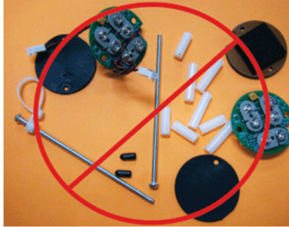
Abbildung 4 Beide Halteschrauben entfernt
