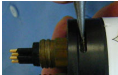
Abbildung 3 Monofilament aus dem Endflansch ziehen
