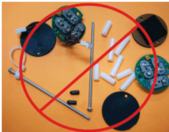
Figura 4 Situación con ambos tornillos de sujeción quitados
