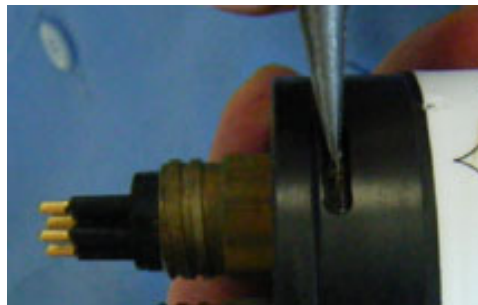
Figura 3 Tire del monofilamento de la brida final.
